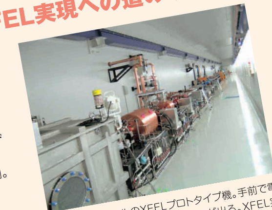
全長約60メートルのXFELプロトタイプ機。手前で電子が生まれ、奥に向かってレーザーが出る。XFEL実機はこの12倍ほどの長さ(約700メートル)になるが、海外のXFELの全長が数キロメートルの長さが必要とするのに比べると格段に短い。
