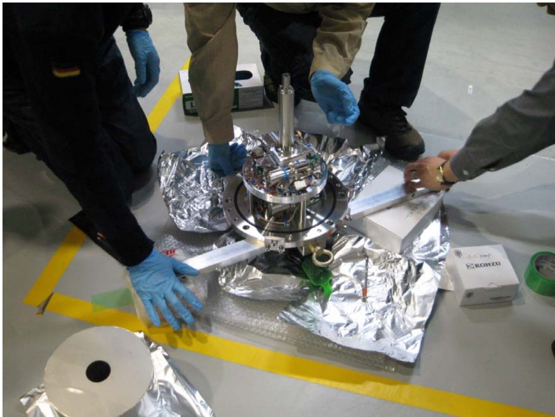
図 18 EH3 床の静電気でスリットが誤動作したため、現場で原因究明
