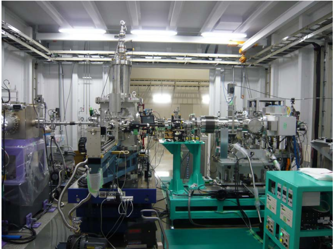
図 16-1 EH3 で室温実験開始前の K-B ミラー (左)、壽壺号 (中)、MPCCD (右)
