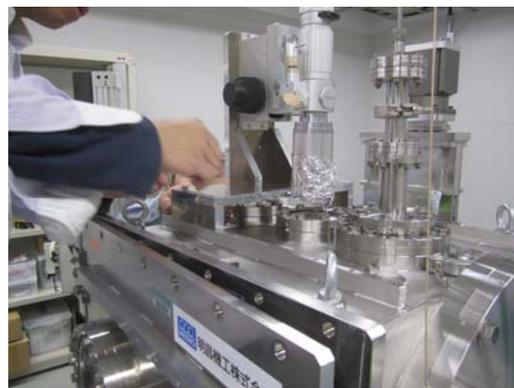
図 5. 長焦点レンズ付 CCD カメラ
