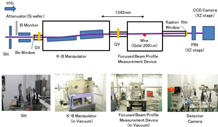
図 2 導入した 1  $\mu\text{m}$  集光光学システム
