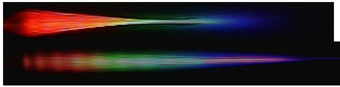
図3 α BBO 結晶 (上) とガラス (下) での白色光発生
