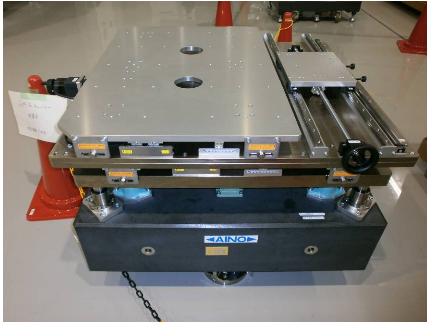
図 2. 今回の研究で開発した、広角 X 線 X 線回折計測設置用架台
