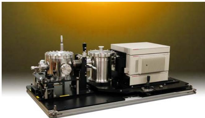
図2 真空紫外ストリークカメラシステム
